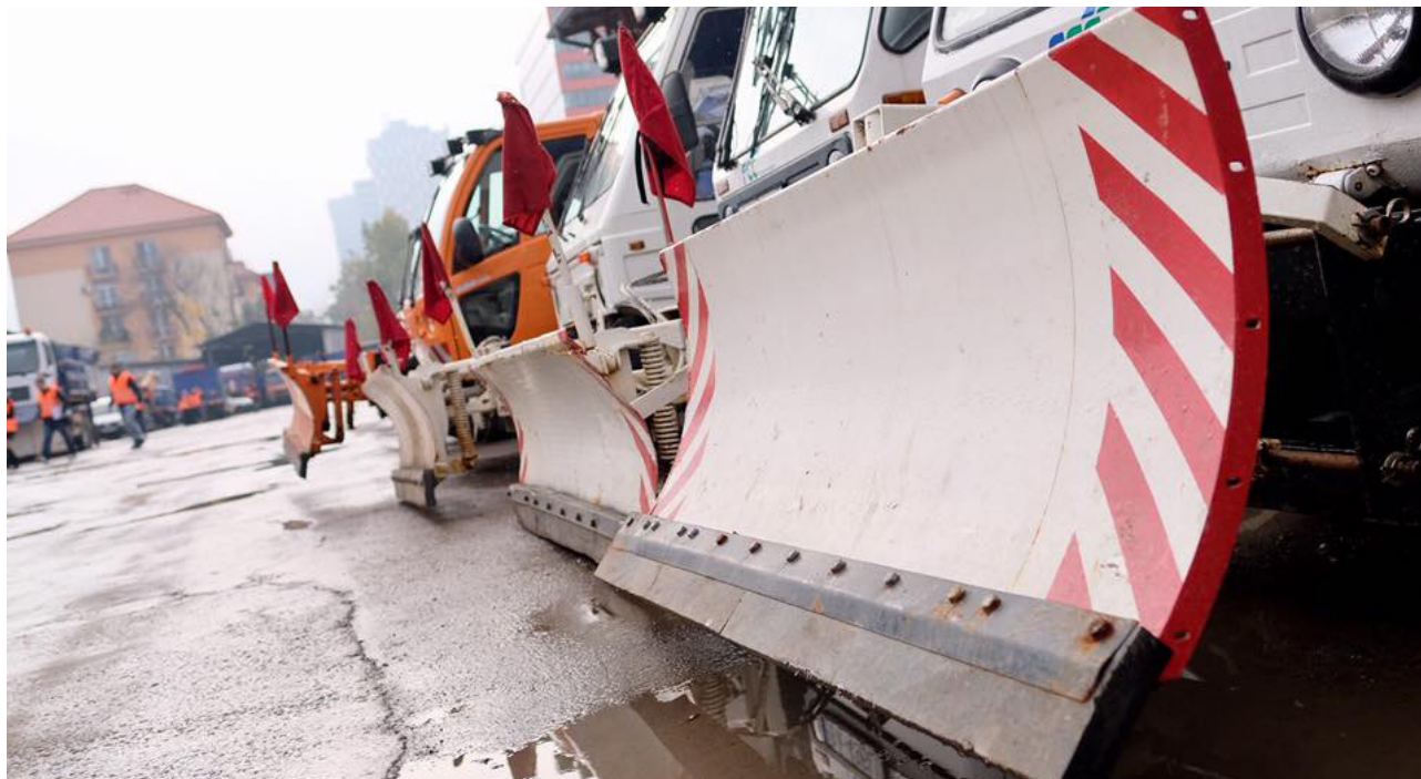
Vehículos quitanieves equipados con dispositivos de monitorización GPS.
